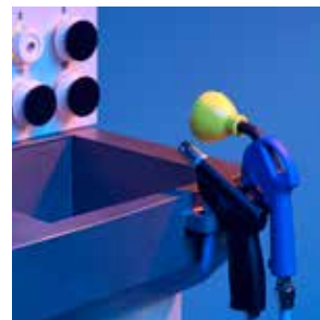
Compartimento para lavagem das lentes com jato de água e pistola de ar comprimido
