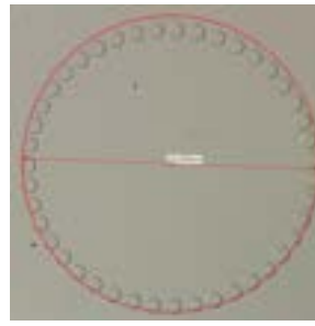
1,6 mm Kreis, gebildet aus 60 \mu\text{m} -Punkten.
