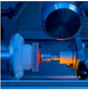
Abblocken per Hochdruckwasserstrahl.
